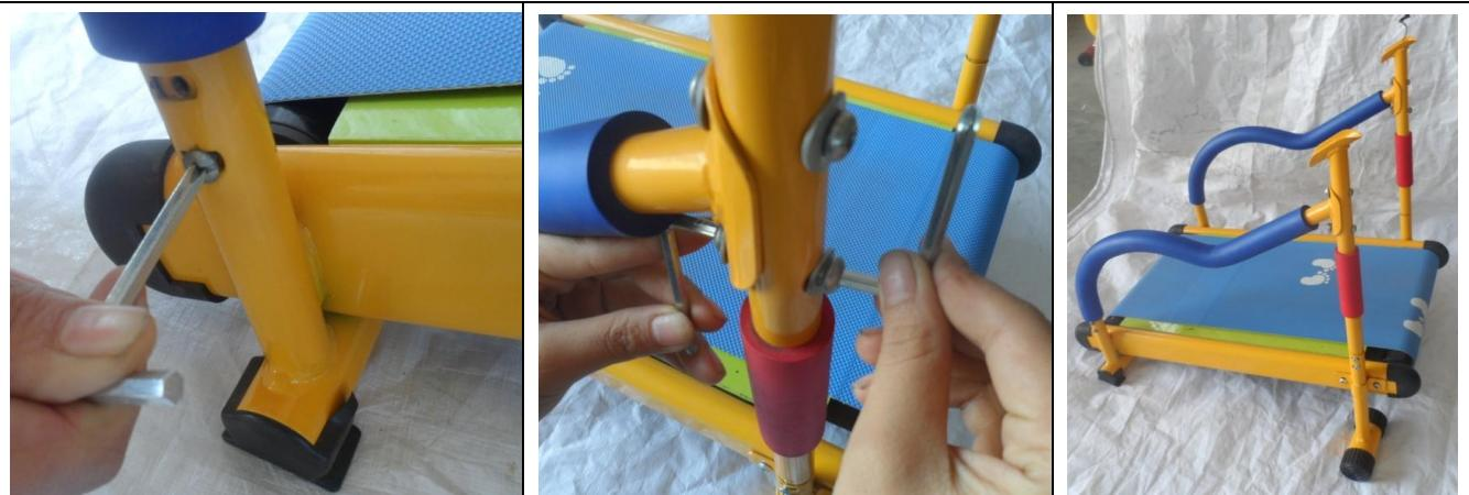
Используя 2 винта, прикрепите с каждой стороны **левый и правый поручень** к **задним ножкам**. Затем, используя 8 болтов и шайб, прикрепите **поручень** к **стойкам** с каждой стороны.
