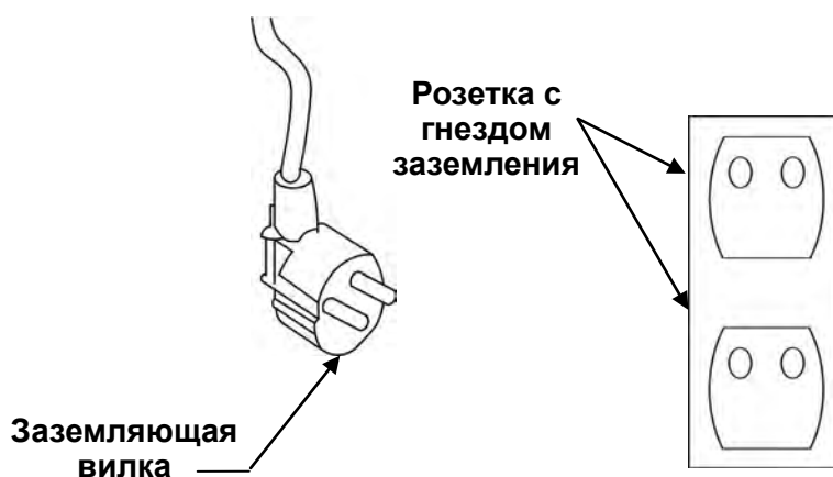
Рисунок 1. Подключение устройства к электросети
