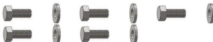
Наружный шестигранный болт (M8×30) / шайба / гайка
